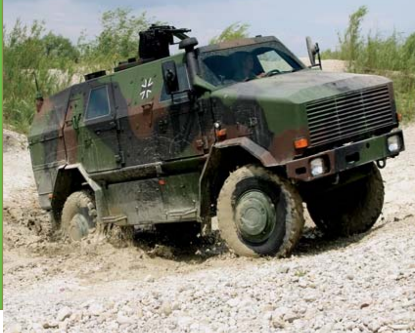
Свеобухватно заштићено возило ATF2 (Dingo2 APV) на тестирању проходности
